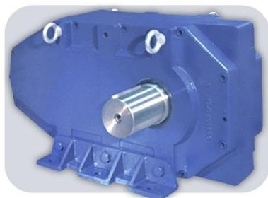
Трёхступенчатый цилиндрический параллельный редуктор на лапах без электродвигателя, максимальное передаточное отношение 125, максимальная мощность 100 кВт.
